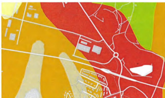
Figur 16. Infiltrationsbenägen jordart med viktig grundvattentillgång är markerad med rött. infiltrationsbenägen jordart med obetydlig eller ingen grundvattentillgång är markerad med brunt. Våtmark är markerad med beige. Silt och lera med underliggande större grundvattentillgång är markerad med grönt.
