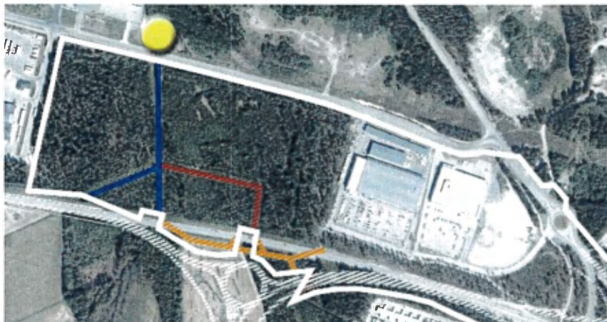
Figur 20. Illustrationen redovisar hur bäcken från Umedalen kan omledas (markerad i orange) eller kulverteras (markerad i rött). Översvämningsbar yta för 100-årsregn är markerad i gult.
