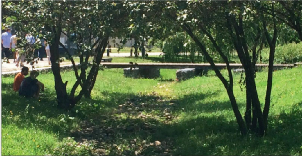
Figur 30. Exempel på översvämningsbara ytor. Översvämningsbara ytor står i regel tomma vid normalväder, men fylls i samband med stora regnhändelser. Bildkälla "Gröna dagvattenstråk" av LTU Dag&Nät, Grön Nano m.fl.
