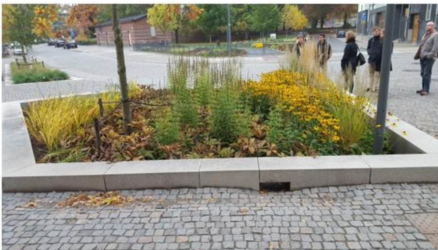
Figur 24. I figuren redovisas ett exempel på hur en växtbädd kan utformas i gatumiljö (WSP, 2019).
